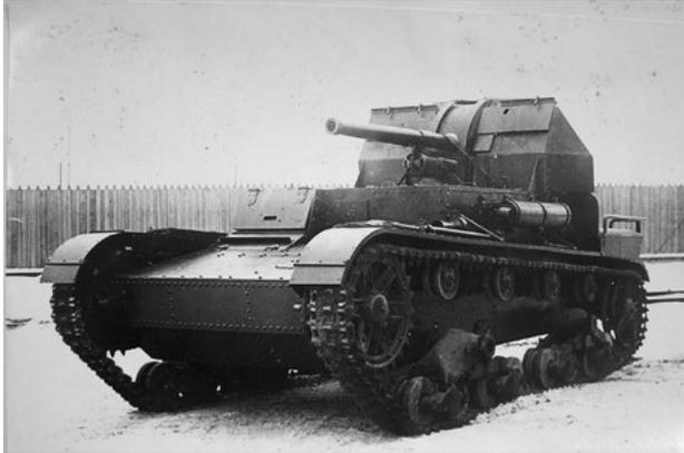
Самоходная установка СУ-5-1 с модернизированной полковой пушкой калибра 76,2 мм.
