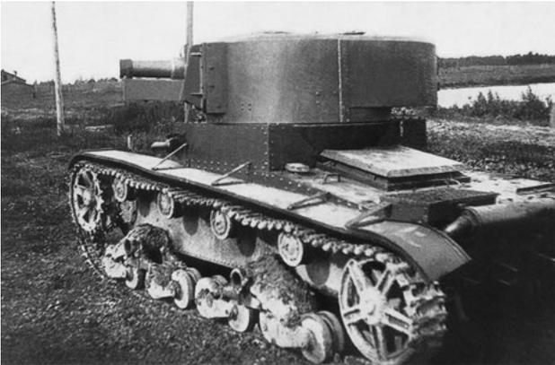
Артиллерийский танк Т-26-4.
